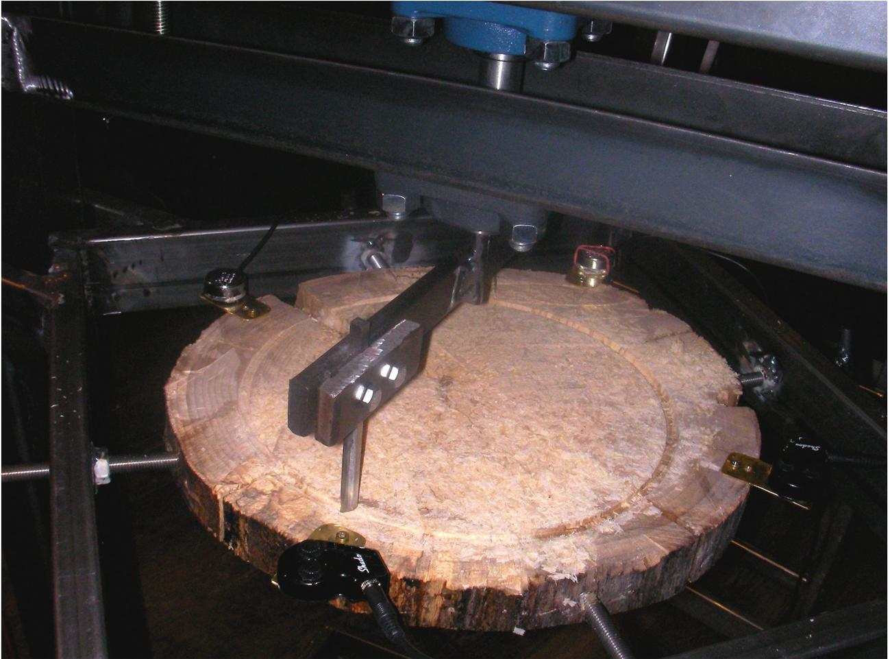
*Abbildung 2: Holzrohling eingespannt mit Piezo-Tonabnehmer*
